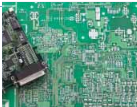
無電解銀めっきで処理したプリント配線板
