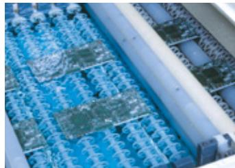
パソコンやスマートフォンなどの電子機器に使用されているプリント配線板は、地球環境保護の観点から、無鉛はんだを用いた部品の高密度表面実装が主流となっています。タフエースは、はんだ付けが難しい無鉛はんだでも顧客が要求する良好なはんだ付け性を提供できる耐熱型水溶性防錆剤です。また、タフエースは有機溶剤を含まないため、人と地球に優しい作業環境を提供します。
