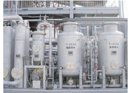
不溶性硫黄製造工程で使用する二酸化炭素を回収する装置です。
