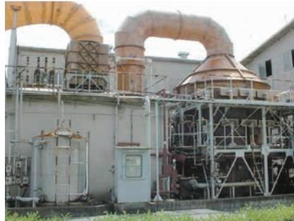
塩素化イソシアヌル酸製造工程で発生する塩素を集合させて洗浄処理する設備です。
