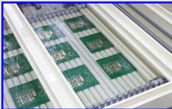
■ タフエース処理槽を通るプリント配線板
