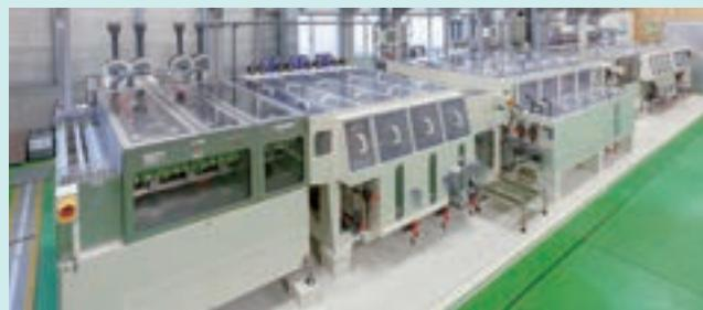
プリント配線板の銅表面を粗化することなく、化学的に銅と樹脂の密着性を向上させる「GLiCAP」。2018年3月、R&Dセンター内の処理設備を拡充しました。この設備を活用し、様々な用途や量産稼働に応じたきめ細かな技術サポート体制を更に強化してまいります。
